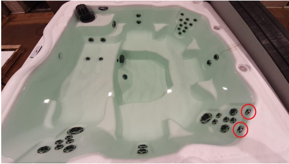
Bild 2: Bilden visar vattennivån under provet. Badet är fyllt över rekommenderad nivå, uppmätt till ca 270 liter (+22%) mer vatten än normalt. Därför är resultaten på energiförbrukningen något högre än vad som erhållits normal vattenvolym.
